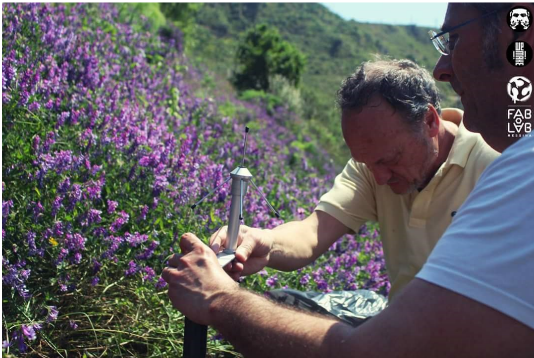
Fig. 4 - Installazione di un sensore di frana presso Giampileri (ME) con l'aiuto dei partecipanti al workshop tenuto presso il FabLab Messina.
